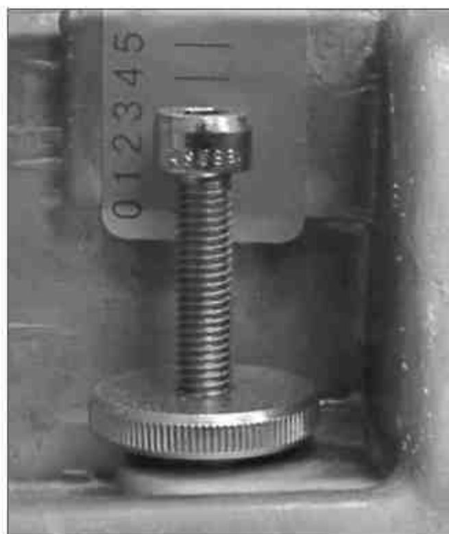
Рис. 6: Настройка воздушной заслонки
